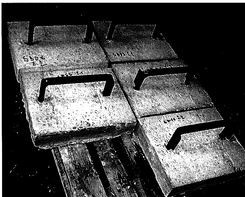
Stupadla KASI – SBDS a SBSS KASI EN 13101 MSS DII po zkoušce
